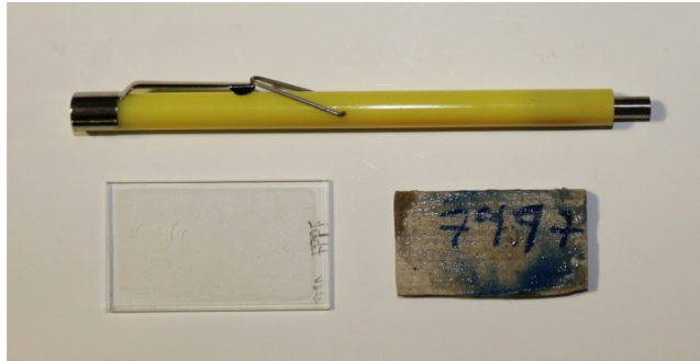
Abb. 2: Dünnschliff der zu untersuchenden Gesteinsprobe. (Magnetstift = 12,5 cm)
